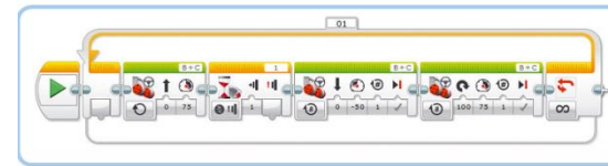
Рис. 6.6. Программа TouchAvoid. Блок Ожидание настроен на режим Датчик касания → Сравнение → Состояние
