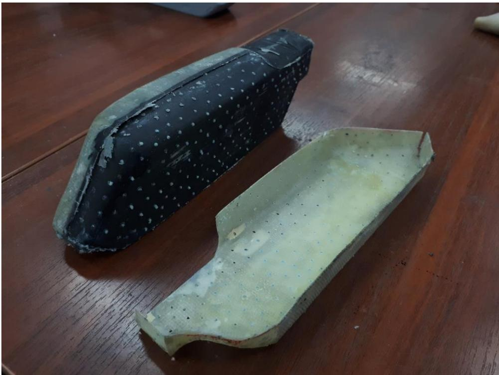
Корпус модели из углепластика и прижимная корочка (цулага).
