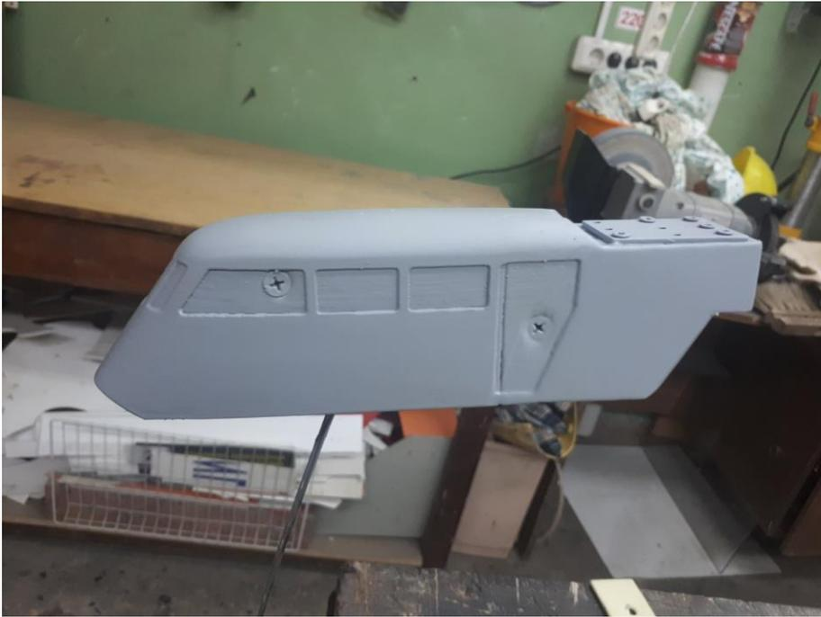
Составная мастер-модель корпуса, напечатанная на 3Д принтере
