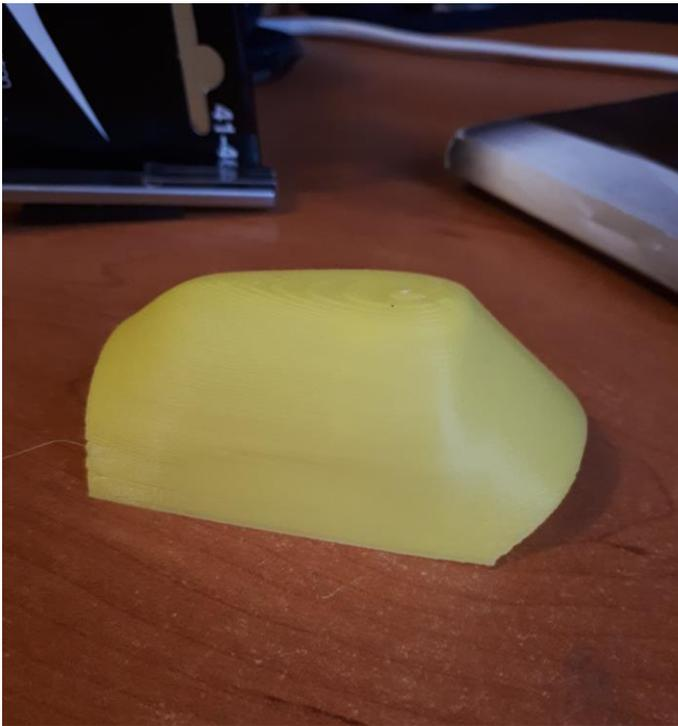
3Д мастер-модель капота, напечатанная на 3Д принтере.
