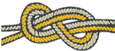
Из-за большого трения узел очень надежен и не требует контрольных узлов, может применяться на плоских лентах.
